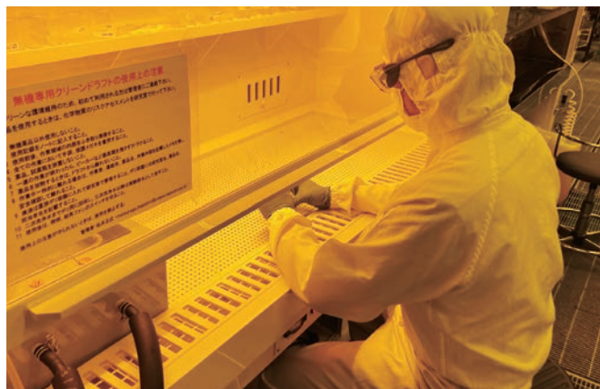
クリーンルーム内でCNTデバイスを作製する様子 (左)フレキシブル基板上へのCNT成膜 (右)電子線蒸着による金属電極形成
