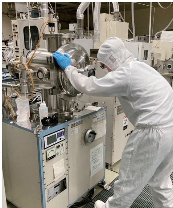
クリーンルーム内でCNTデバイスを作製する様子 (左)フレキシブル基板上へのCNT成膜 (右)電子線蒸着による金属電極形成
