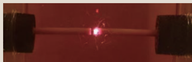
SPP法により、金属ナノ粒子が電解質溶液中に生成される。高分子干渉材を用いることなく凝集(原子などが多数集まって集塊となること)せず、粒径20nm以下任意のナノ粒径の状態を長期保つことが可能。
