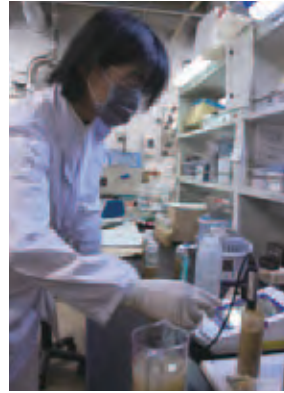
粘土のpH測定をするために、採取してきた物に電極を差している。
