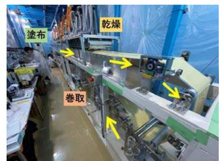
図5：ロール to ロール塗布装置
